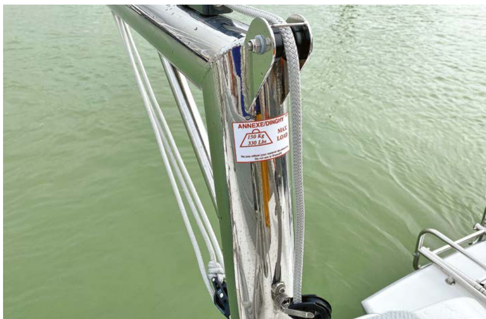
■ Na testowanej jednostce mieliśmy zamontowany na rufie mały wysięgnik o udźwigu 150 kg
